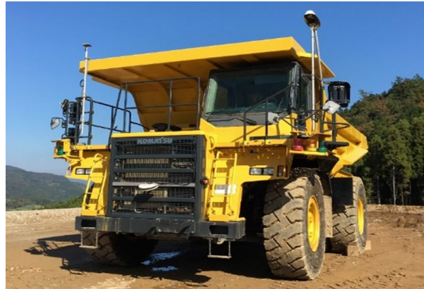
自動ダンプトラック: 搬送、荷下ろし作業の自動化
