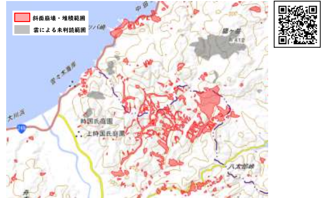
斜面崩壊・堆積分布図（珠州市と輪島市の境界付近）
